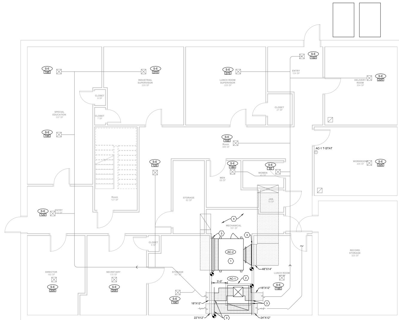
**HVAC GROUND FLOOR PLAN - NEW WORK**
